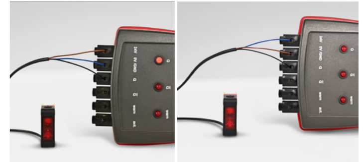
亮/暗通切换通过(电缆)布线的反极性进行(电源正负极线反接)
